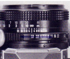
7 Blendenring auf eine gewünschte Blende drehen (Seite 26).
