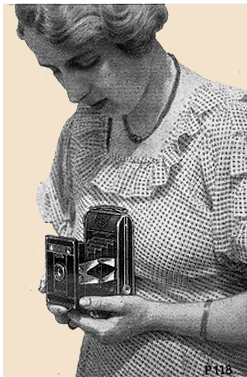
Abb. 10 Richtige Camerahaltung bei Benutzung des Brillantsuchers
